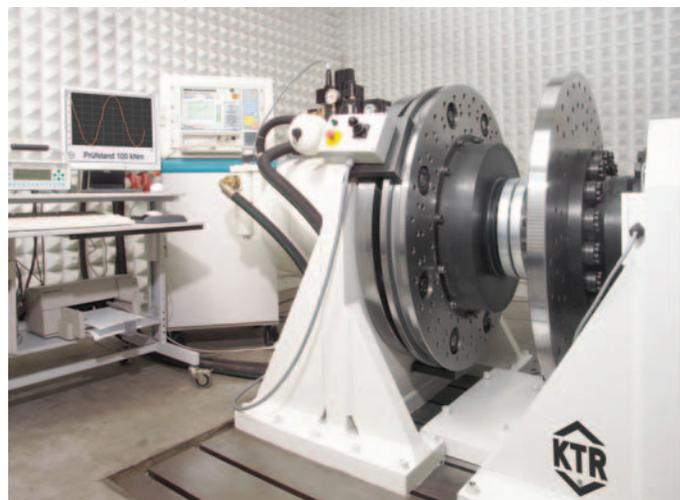
Наш центр исследований и разработок оснащён сервогидравлическим испытательным оборудованием с электронным управлением, а сбор и регистрация данных осуществляется с помощью компьютера. Программное обеспечение, специально разработанное для KTR гарантирует быструю и точную обработку данных. В общем, в центре исследований и разработок установлено десять испытательных стендов с градацией по мощности в исполнении со статической и динамической нагрузкой.
