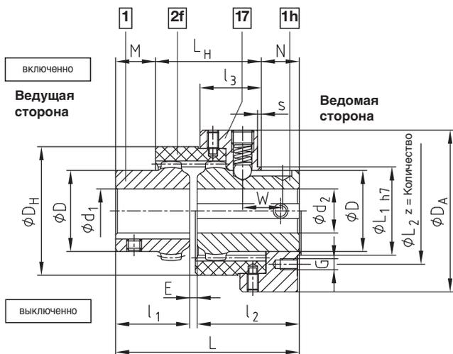
Присоединительные размеры для VoWex® SD - кольца включения (деталь 17) для присоединения: контактного кольца SD1 - см. каталог стр. 81, диск включения и т.д.
